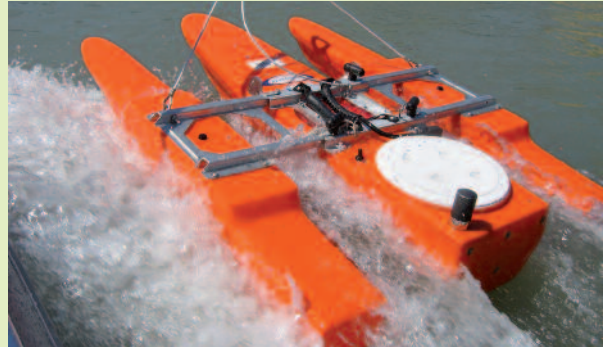
Durchflussmessung mit Ultraschall-Messgerät (ADCP 1) Gerät
