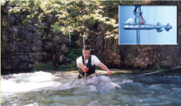
Durchflussmessung mit hydrometrischem Flügel
