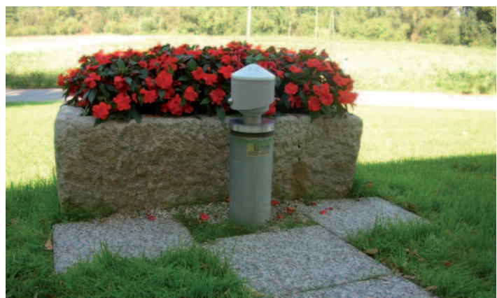
Grundwassersonde mit GPRS-Fernübertragung
