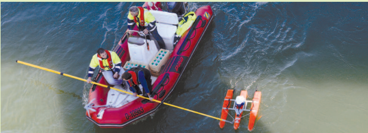
Durchflussmessung mit Ultraschall-Messgerät
